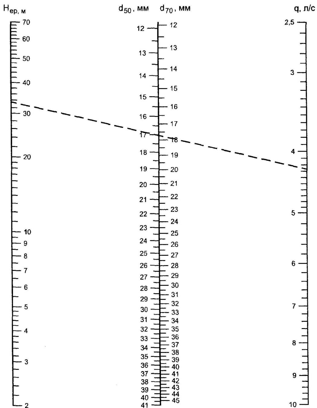
$d_{50}, d_{70}$  – диаметры отверстий диафрагм, устанавливаемых
